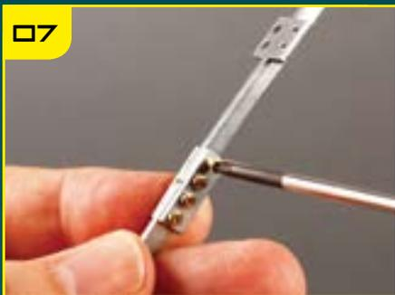
Соедините две половины ребра жесткости с помощью накладки, как вы делали это ранее.
