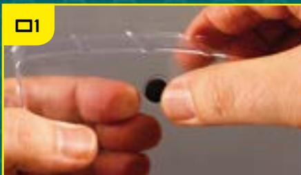
Вклейте противоскользящие наклейки в два углубления новой секции монтажной опоры.
